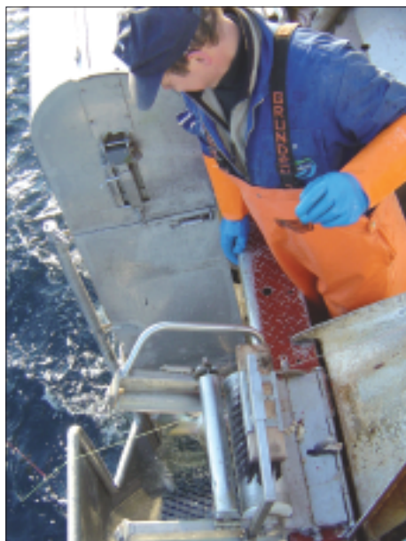
Automatisk linehaler fra Delitek AS, Myre, bringer torsken om bord uten kleppskader.
